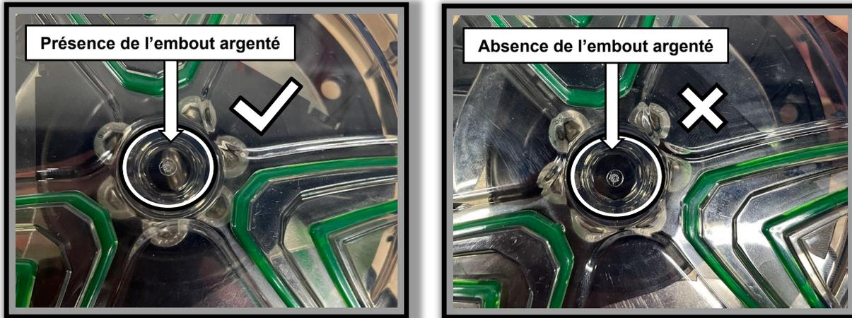
**Figure 2 : inspection visuelle de l'embout**
